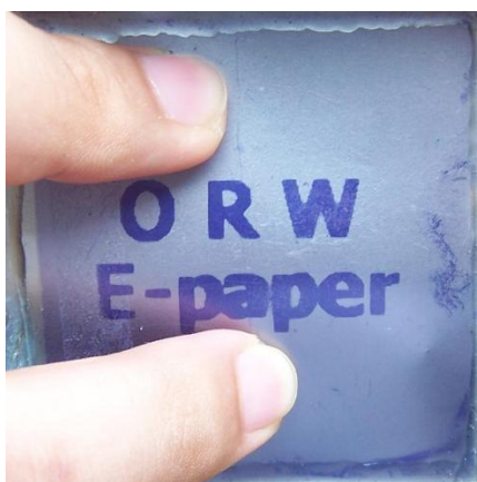
Fig. 6 / Рис. 6. ORW E-paper in plastic substrates is tolerant to mechanical pressure / Оптически перезаписываемая электронная бумага на пластиковых подложках устойчива к механическому давлению
