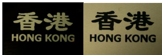
Fig. 4 / Рис. 4. ORW E-paper image under crossed and parallel polarizers / Изображение на оптически перезаписываемой электронной бумаге при использовании скрещенных и параллельных поляризаторов.
