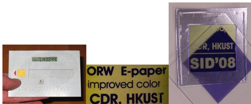
Fig. 5 / Рис. 5. From left to right: ORW E-paper for advertisements, plastic cards and security applications / Слева направо: оптически перезаписываемая электронная бумага для рекламы, пластиковых карт и приложений безопасности
