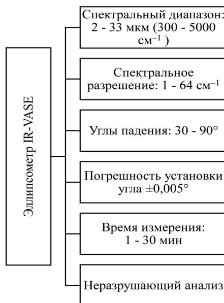
Рис. 3. / Fig. 3. Технические характеристики эллипсометра IR-VASE. /
