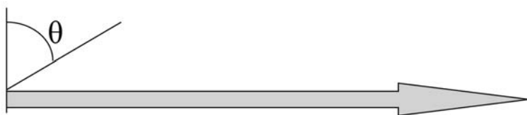
Рис. 2. Угол наклона директора ЖК к направлению прохождения луча отсчитывается от нормали к лучу, то есть от торца цилиндра.
