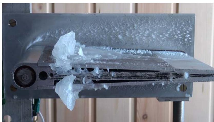
Рис. 2. Барьерный лед на модели через 10 мин после начала намораживания.
