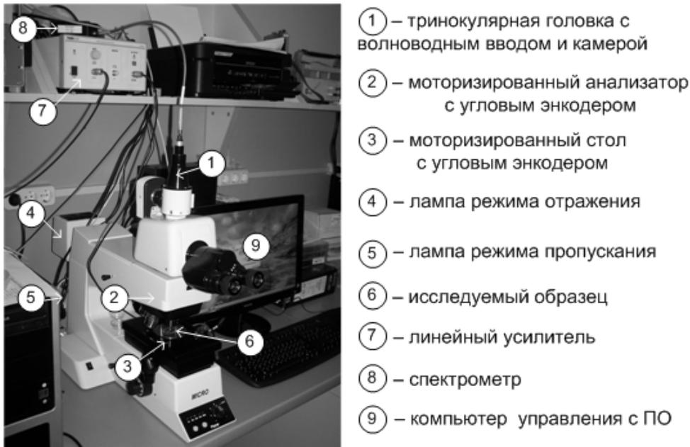
Рис. 1. Автоматизированная установка для одновременного измерения азимутальной и поляриной энергии сцепления ЖК в одной твист нематической ячейке
