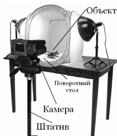
Рис. 1. Аппаратная часть комплекса для реконструкции
