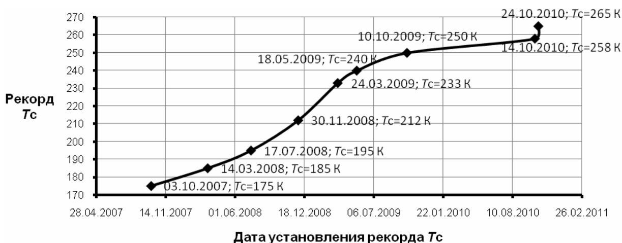
Рис. 1. Зависимость открытия рекордных температур перехода в сверхпроводящее состояние во времени
