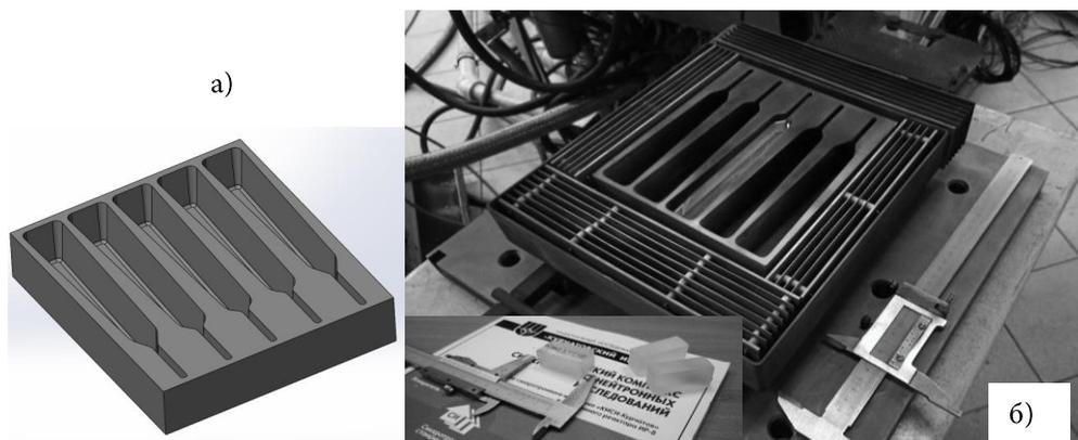
**Рис. 1. / Fig. 1** Тигель из графита марки Sigratine R-4550 (а) и выращенный монокристалл  $140 \times 23 \times 20$  мм  $\text{CaF}_2$  в средней ячейке 5-ти ячеистого графитового тигля (б); на вставке – шлифованные образцы для исследований / Sigratine R-4550 graphite crucible (a) and grown  $\text{CaF}_2$  single crystal  $140 \times 23 \times 20$  mm in the middle cell of a 5-cell graphite crucible (b); the insert shows polished samples for research.
