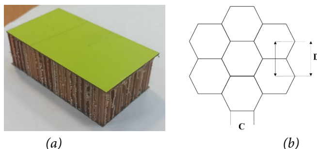
Рис. 1 / Fig. 1. Общий вид образца (a) и размеры сот (b). Сторона соты C = 3 \text{ mm} и D = 5,2 \text{ mm} / (a) General view of the sample and (b) dimensions of the cells. Honeycomb side C = 3 \text{ mm} and D = 5,2 \text{ mm}
